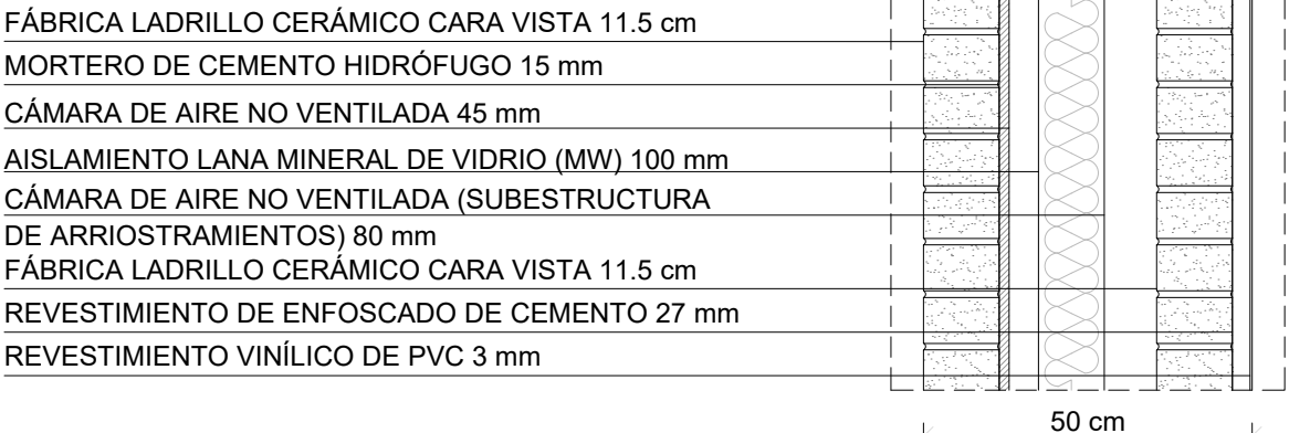
M3 FACHADA DE FÁBRICA DE LADRILLO CERÁMICO CARA VISTA, CÁMARA DE AIRE NO VENTILADA, AISLAMIENTO INTERIOR Y TRASDOSADO DE FÁBRICA DE LADRILLO CON REVESTIMIENTO INTERIOR DE PLACA DE YESO LAMINADO
