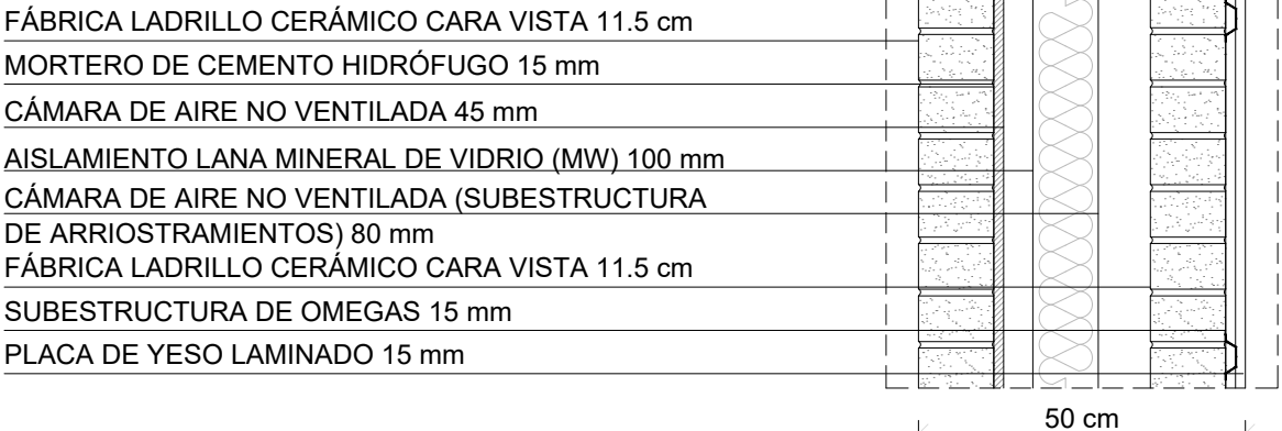
M3 FACHADA DE FÁBRICA DE LADRILLO CERÁMICO CARA VISTA, CÁMARA DE AIRE NO VENTILADA, AISLAMIENTO INTERIOR Y TRASDOSADO DE FÁBRICA DE LADRILLO CON REVESTIMIENTO INTERIOR DE PLACA DE YESO LAMINADO
