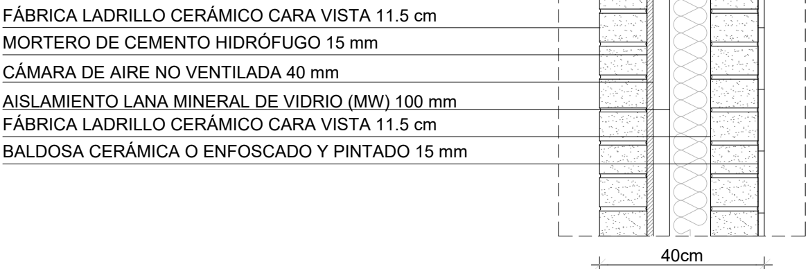
M2 FACHADA DE FÁBRICA DE LADRILLO CERÁMICO CARA VISTA, CÁMARA DE AIRE NO VENTILADA, AISLAMIENTO INTERIOR Y TRASDOSADO DE FÁBRICA DE LADRILLO CON REVESTIMIENTO INTERIOR VINÍLICO DE PVC
